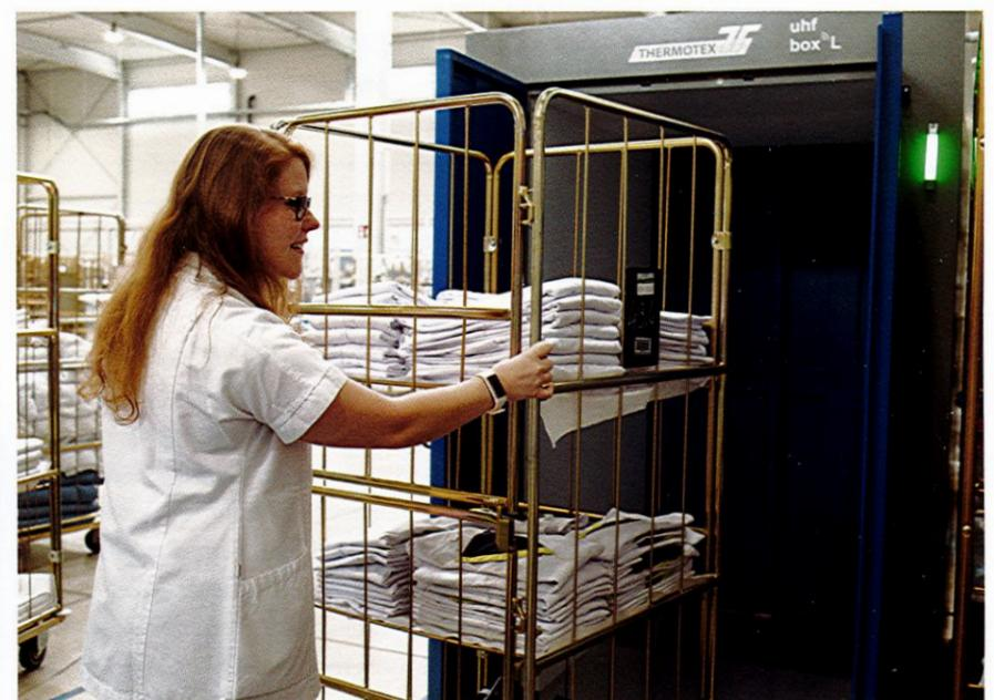
Vor dem Versand werden die Textilien mit Transpondern im Tunnel abgescann und damit der Bestand aktualisiert.
