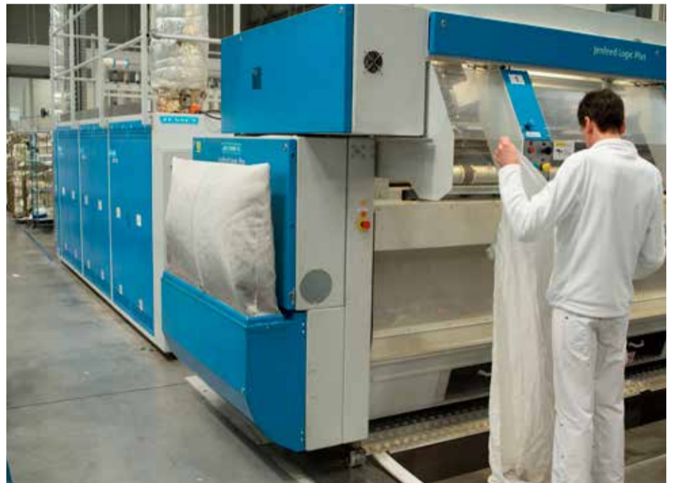
Die neue 3-Rollen-Mangel reduziert den Bedarf bei der Wärmeerzeugung.
